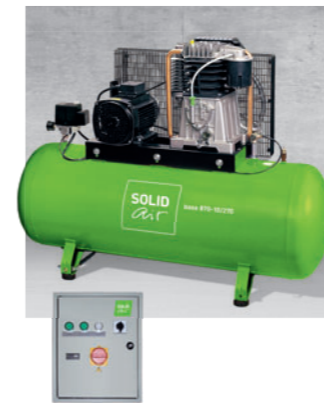
SOLIDbase 520-10 bis 1300-10 / 440-15 bis 1000-15 12 stationäre Kolbenkompressoren mit liegendem Behälter, 10 und 15 bar, inkl. Sternendreieck-Schutzkombination (bei 5,5- und 7,5 kW-Version fertig verdrahtet mit dem Kompressor), Condor-Qualitätsdruckschalter mit Betriebsstundenzähler
